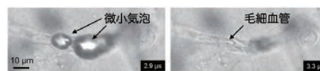
Fig. 1 毛細血管ファントム内での微小気泡ダイナミクスの高速度観察
